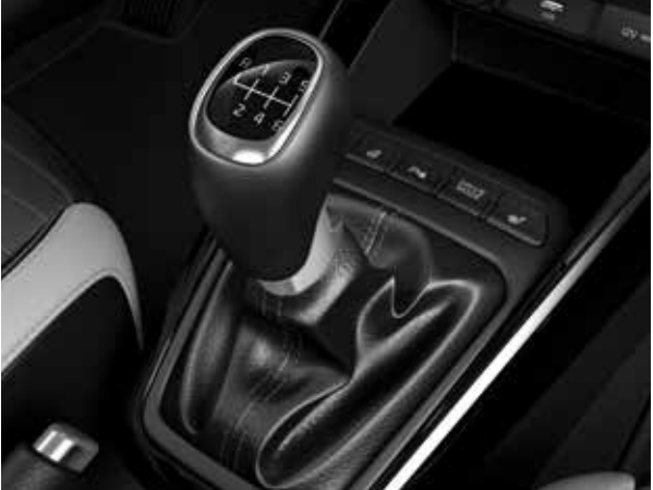
Boîte manuelle. Le Kia Stonic se dote de deux types de boîte manuelle à 6 rapports : une classique (BVM6) sur la motorisation 1.0 essence T-GDi 100 ch ISG BVM6, et une dotée d'un embrayage électronique (iBVM6) si elle couplée au système MHEV.
